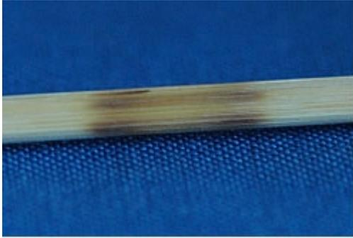
Der Holzspan ist an einigen Stellen verkohlt. Die verkohlten Stellen sind am Rand der Flamme entstanden. An diesen Schwärzungen erkennt man, dass die Flamme am Rand heißer ist als im Inneren. Die Flamme besteht aus verschiedenen Flammenzonen, die auch verschiedene Farben haben können und verschiedene Temperaturen haben. Je nach Zone verbrennt der Holzspan schneller.
